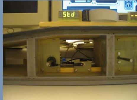
Nachdem alle Drehcodierer ausgerichtet und vollkommen leichtgängig arbeiten, kann mit der Einbindung der Hardware in FSBUS begonnen werden. Mehr dazu findet ihr später unter Schnittstellen.
